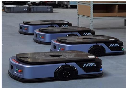
图 18 平板 AGV 机器人
