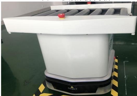
图 17 辊道 AGV 机器人
