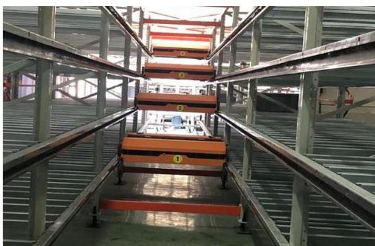
图 15 多层穿梭车货架
